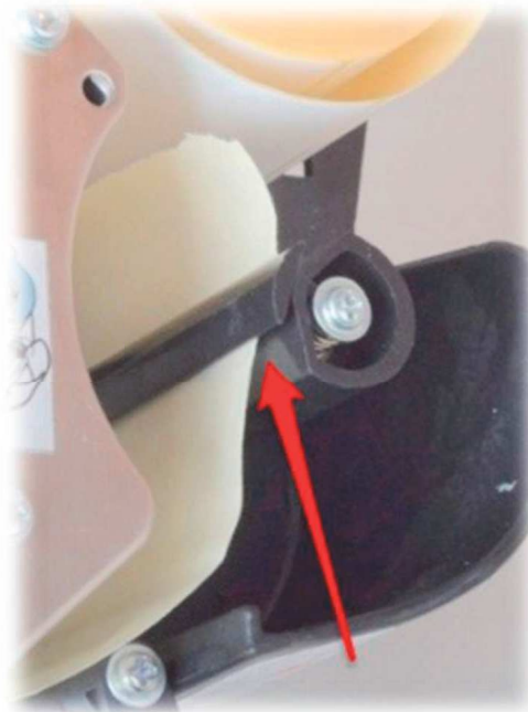
6. Пропускаем конец ленты через катушку таким образом.
