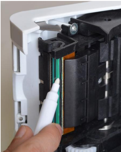
5. Удалите грязь с помощью спец. карандаша или спиртовой салфетки
