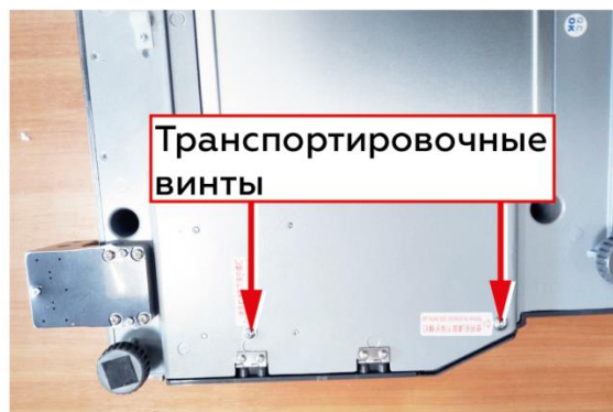
2. Удалите транспортировочные винты
